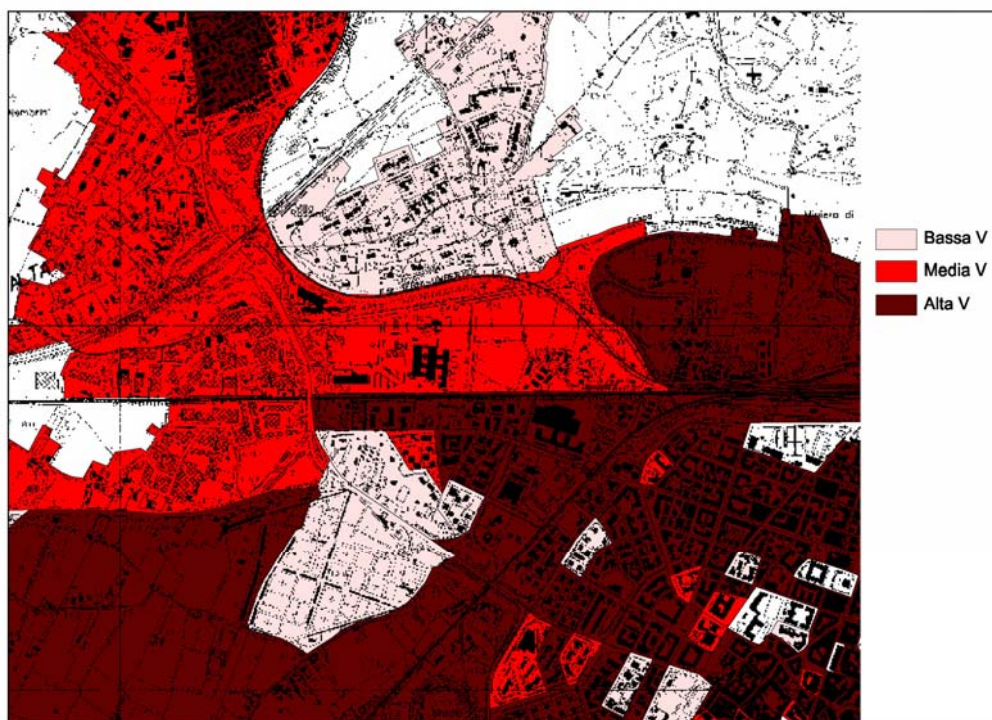
Fig. 9 – Grado di vulnerabilità delle sezioni censuarie in funzione dell'epoca di costruzione
